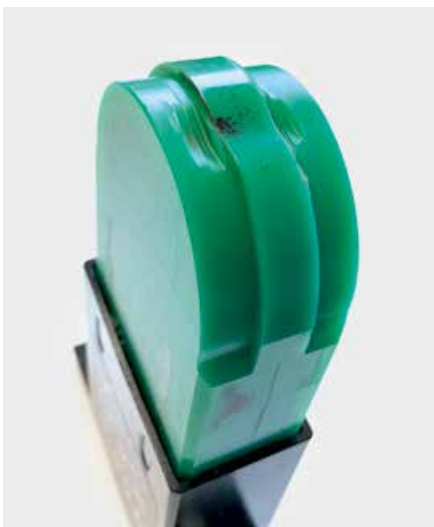
Mögliches Verschleißbild durch Überlastung der Spann-Box®
